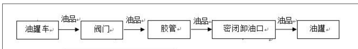
图 2.2-4 柴油卸油工艺流程图
