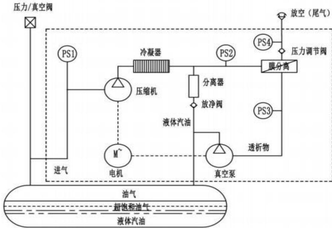
图 2.3-5 三次油气回收工艺流程图
