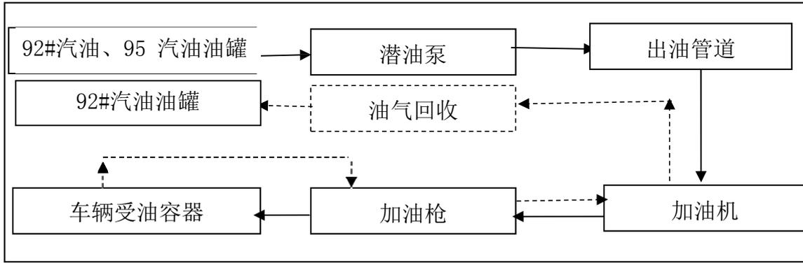
注：虚线箭头表示油气回收工艺路线。
