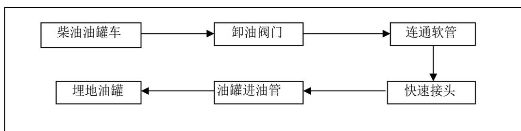
图 2.3-2 柴油卸油工艺流程图
