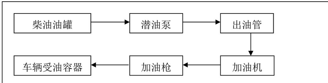
图 2.3-4 柴油加油工艺流程图
