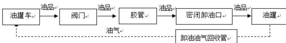
图 2.2-3 汽油卸油工艺流程图
