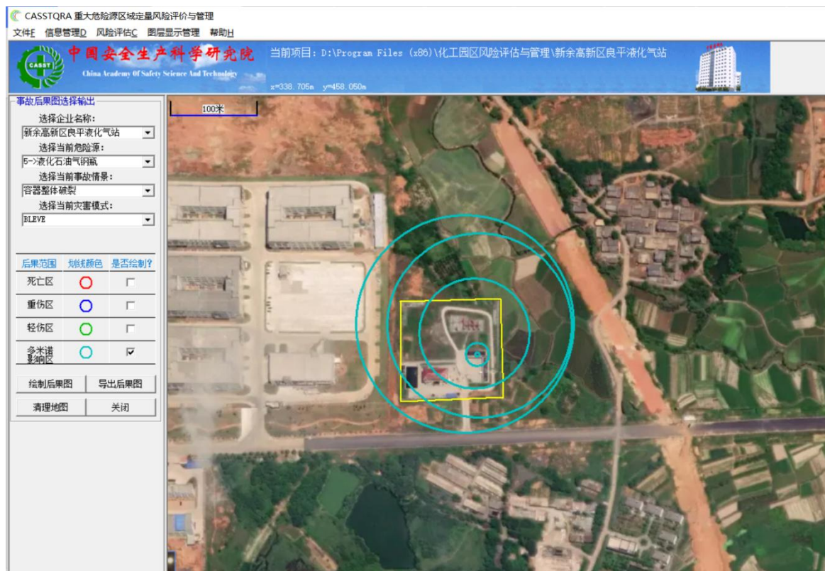
图 5.1-1 该液化气站多米诺影响范围图
