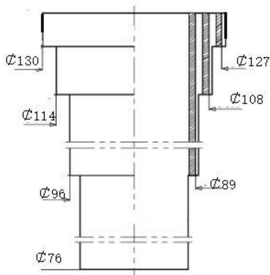
图 2-1 钻孔结构图
