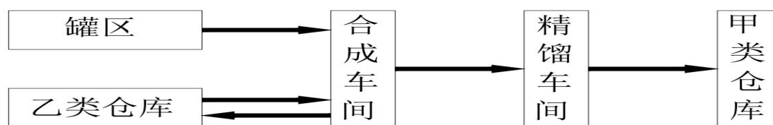
图 2-8 本项目主要生产装置上下游之间关系一览图
